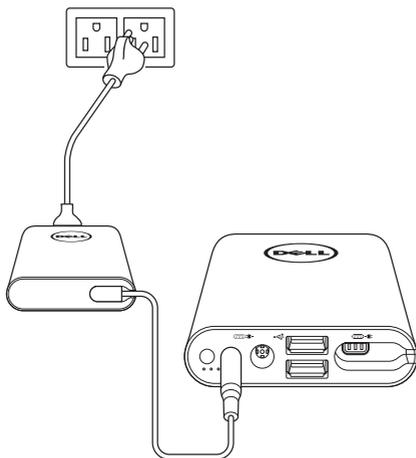
1. 將 Dell 電腦的電源適配器一端插入 power companion 的電源輸入連接埠。
