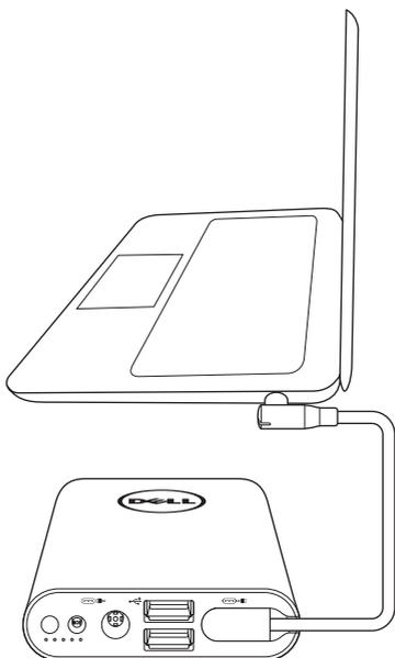
1. 將電源輸出線一端插入 power companion 的電壓輸出連接埠。
