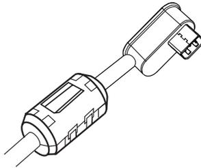
使用 PW7015M 型產品時，適配器功率如為 90 瓦，請將鐵芯掛上行動電源的電源輸出線。
